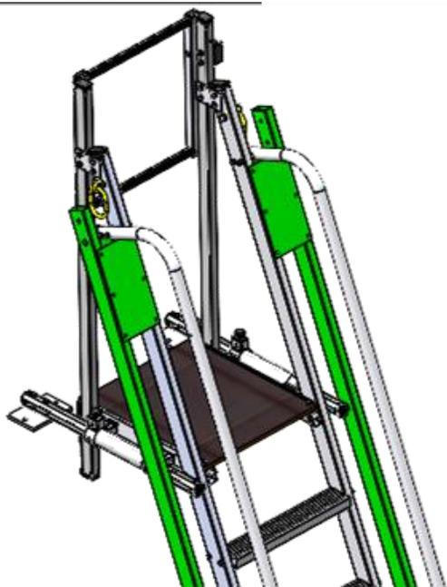
À l'aide des plats de fixation des montants support, contre percer les montants d'échelles au centre avec un forêt de  $\varnothing 8,5$  mm.
