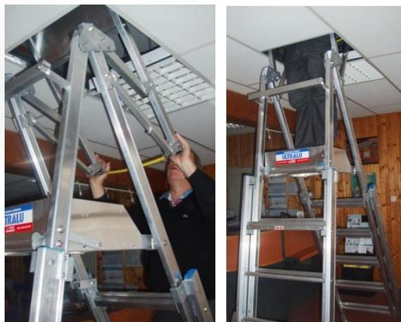
Garde-corps étroit pour passage dans une trappe de 600 x 600 mm
