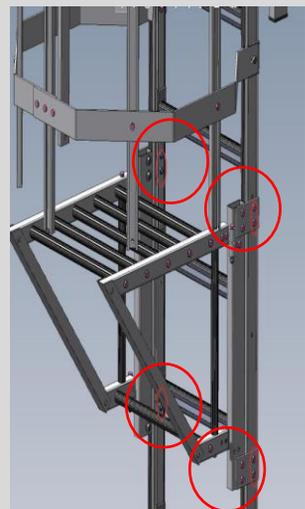
4 trous par montants d'échelle sont à contre-percer
