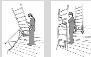
Schéma : Verrouillage des crochets bascules
