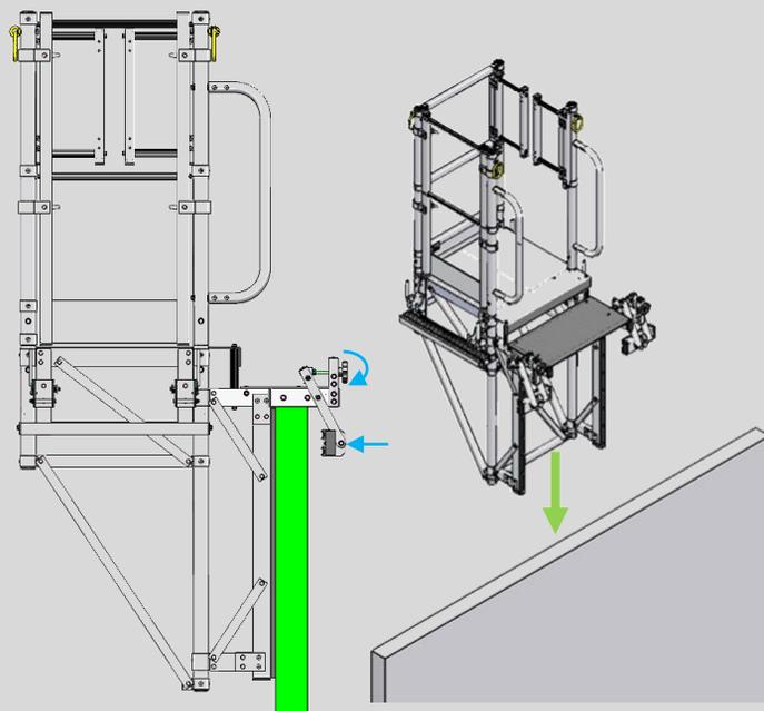
Utiliser les anneaux de levage pour installer la plateforme sur le blindage.
