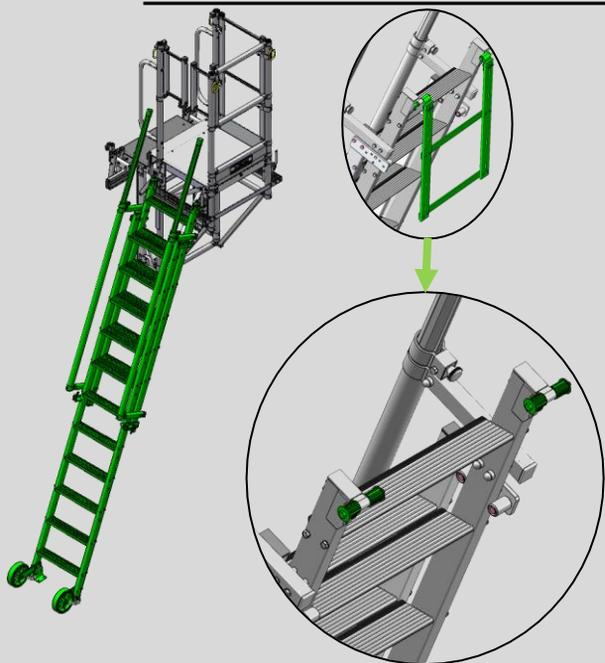
Pour positionner le MAD SKD, l'assemblage du kit d'accroche est nécessaire.
