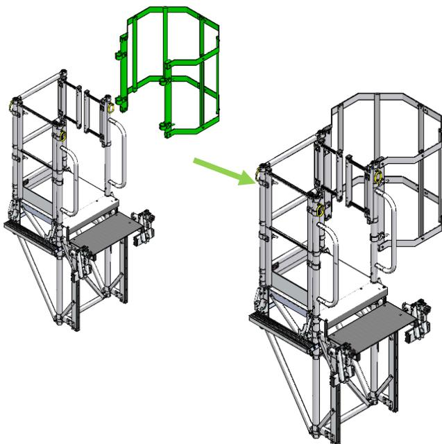
Installer la protection des demi-coquilles. Système de fixation similaire au garde-corps amovible.
