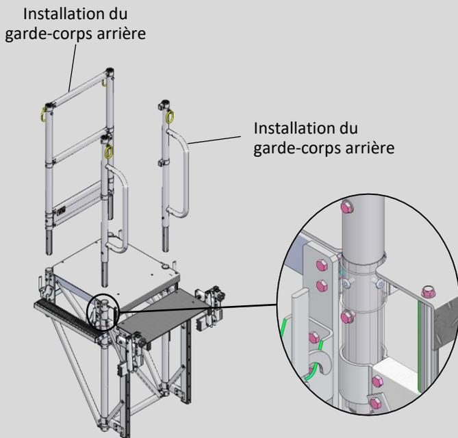
Installer les garde-corps et poteaux de garde-corps.
