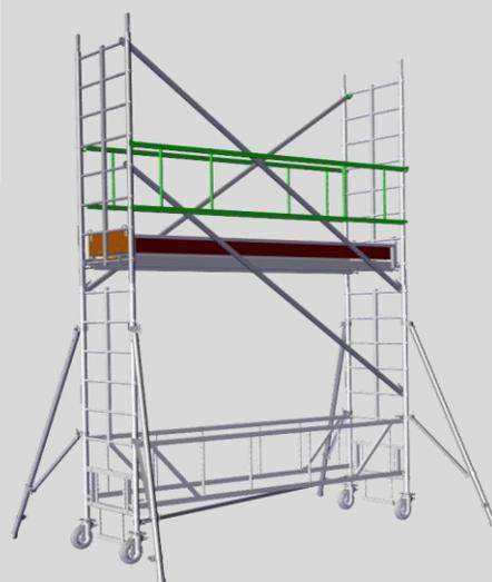
Poser le plateau de repos et verrouiller les crochets.
